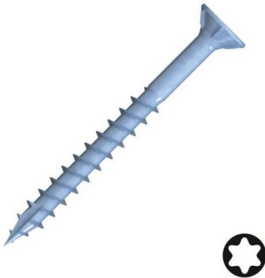
Vis agglo avec ailettes de fraisage et pointe anti éclatement application : vissage en intérieur utilisation : usage universel, construction en bois, aménagement intérieur, construction de meubles résistance au vissage réduite grâce au revêtement téflonné empreinte TORX filetage partiel.
