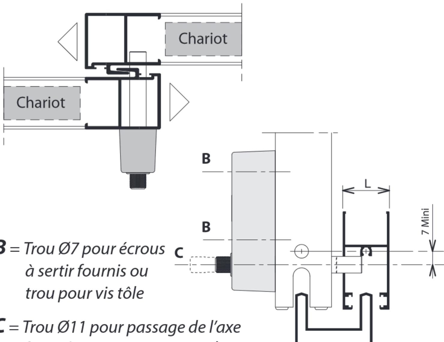
**B** = Trou Ø7 pour écrous à sertir fournis ou trou pour vis tôle
