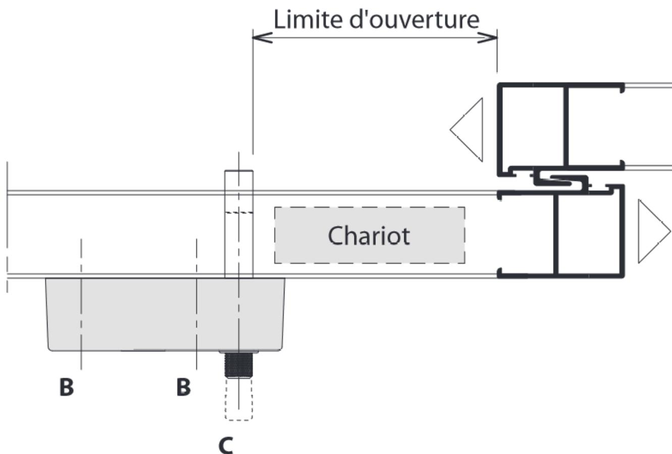
**B** = Trou  $\varnothing 7$  pour écrous à sertir fournis ou trou pour vis tôle
