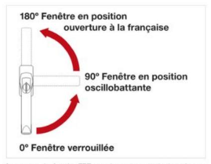
Important : La fonction TBT est uniquement garantie si une ferrure adéquate (TBT) est installée
