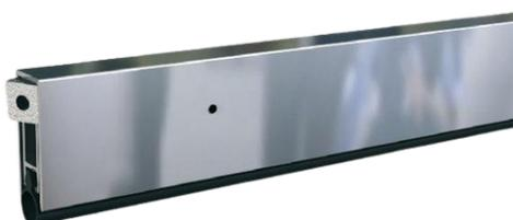
Bas de porte rétractable en aluminium naturel, tout comme son mécanisme intérieur. Ce mécanisme intérieur est muni d'un joint tubulaire en silicone souple qui permet une étanchéité parfaite lors de la fermeture de la porte. Le poussoir règle l'importance de la descente de joint par simple vissage, et intègre un système automatique d'adaptation aux << faux niveaux >>.
