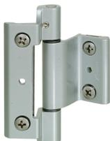
Corps de paumelle en aluminium extrudé anodisé ou laqué. Axe de rotation en acier inox. Douilles de rotation en nylon autolubrifié. Vis et plaques de fixation en acier inox, pré-montées. Predisposition pour la goupille de sûreté pour éviter le glissement vertical. Aspect externe identique à les paumelles de Oscillo-Battant GALIPLUS
