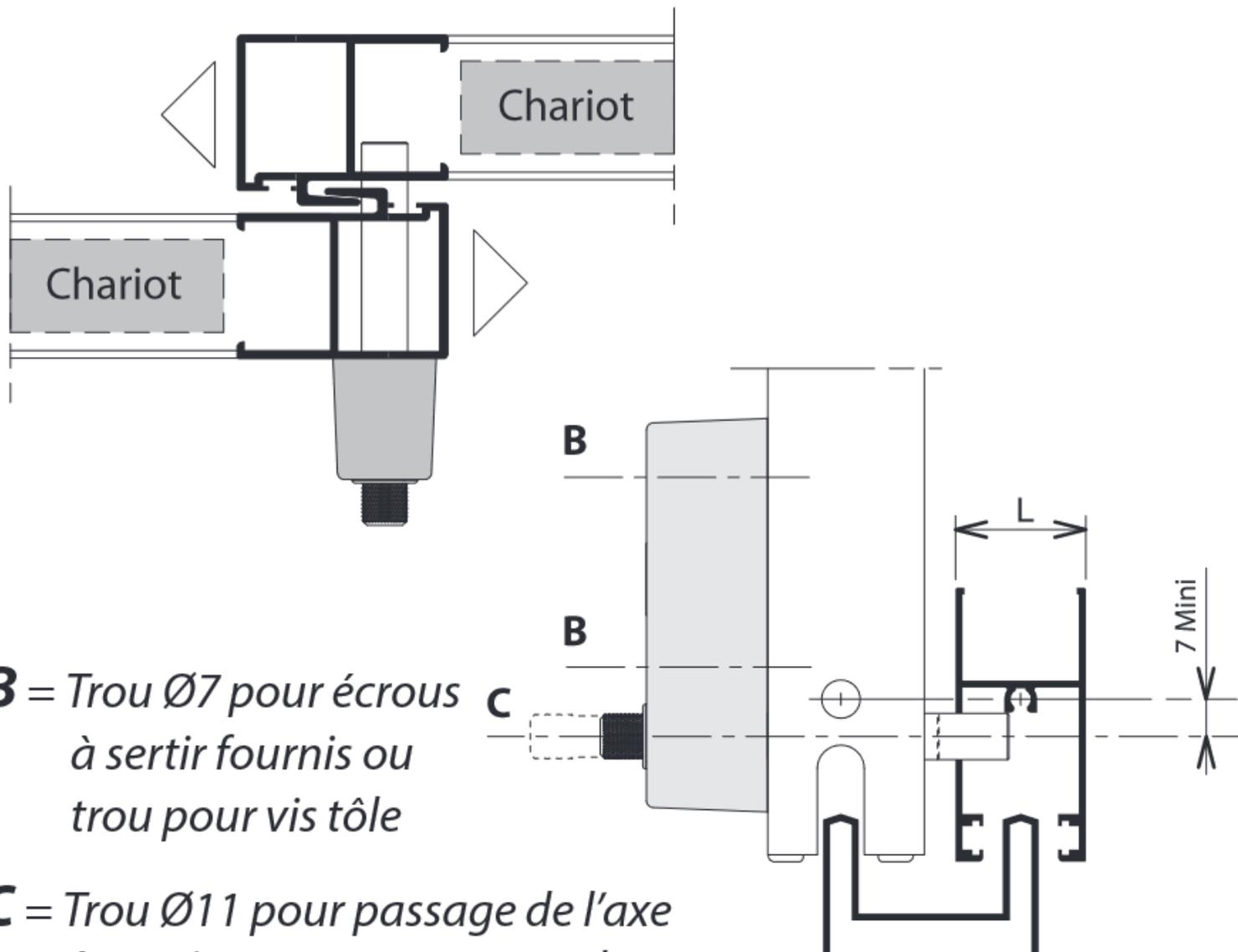
**B** = Trou  $\varnothing 7$  pour écrous à sertir fournis ou trou pour vis tôle
