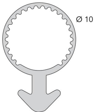
Joint tubulaire silicone diamètre 10 mm - ANCRE 10
