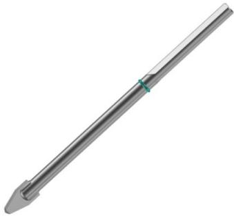
Foret à pointe diamantée Pour pierres naturelles, tuiles, carrelages, céram 3 méplats sur la tige du foret évitent le blocage des forets dans le matériau Changer de forets dès que le matériau fragile est traversé .
