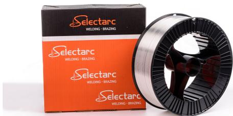
Métal d'apport Al-Mg utilisé pour le soudage des alliages d'aluminium type AlMg5, 5056, 5083, 5454, 6005 A
