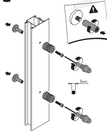
**3** Placer la poignée sur les blocs de fixation ;
