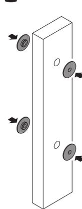
**3** Poser la poignée extérieure et les blocs de fixation sur le profil, puis serrer le tout à l'aide des vis ;
