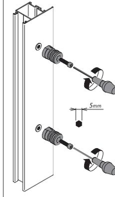
**4** Placer la poignée sur les blocs de fixation ;
