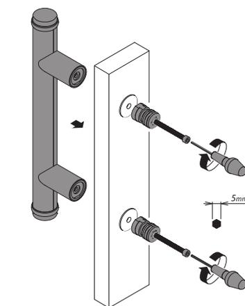
**4** Placer la poignée intérieure et les enjoliveurs sur les blocs de fixation ;
