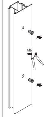
**3** Poser les blocs de fixation ;
