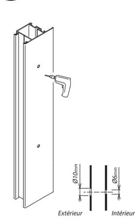
**2** Poser les blocs de fixation ;
