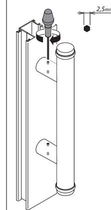
Les blocs de fixation sont équipés d'un système de rattrapage automatique du jeu de serrage !
