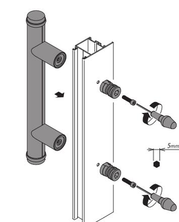
**3** Placer la poignée intérieure sur les blocs de fixation ;
