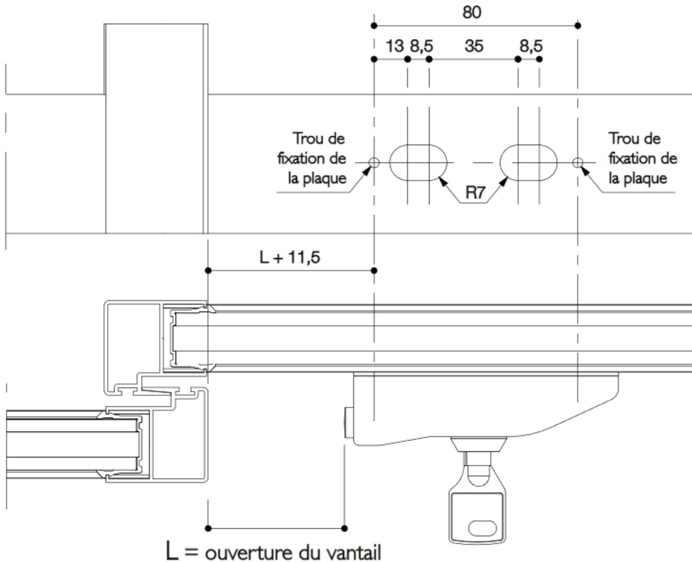
La cote **L** doit être définie en fonction des réglementations en vigueur.
