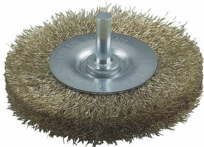
Idéale pour l'enlèvement de coloration sur les cordons de soudure. Convient pour les travaux de nettoyage faciles à moyennement difficiles sur de petites surfaces, dans des rainures ou sur des chants sur des métaux ferreux et non ferreux, notamment pour le dérouillage, le dépolissage, la matification, le dévernissage, le travail du bois. Pas de corrosion grâce aux fils laitonnés
